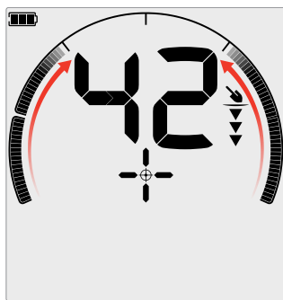
สัญญาณวัตถุเป้าหมายที่อ่อน/อ่อนออกศูนย์กลาง: เปิดเซกเมนต์ความสามารถในการคัดแยกโลหะเนื่องจาก วัตถุเป้าหมายอยู่ใกล้กับด้านนอกของขดลวดมากขึ้น
